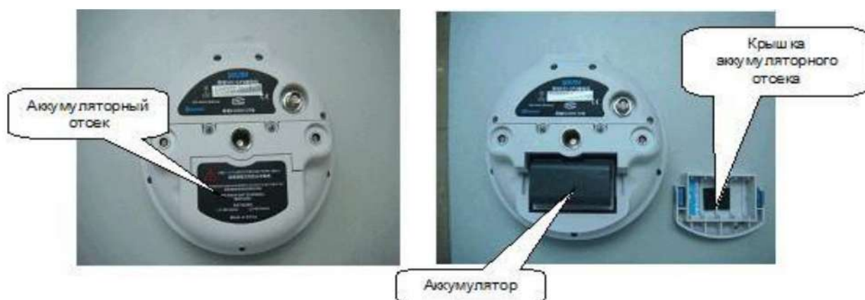
Рисунок 2.3 – Установка аккумулятора в S82V
